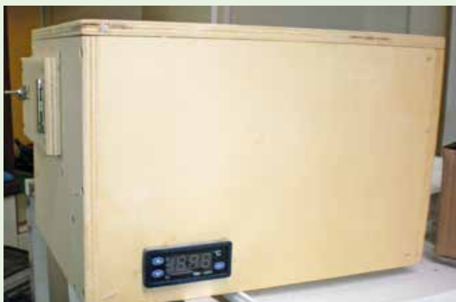
▲ Teplotu v budce řídí termostat s displejem
